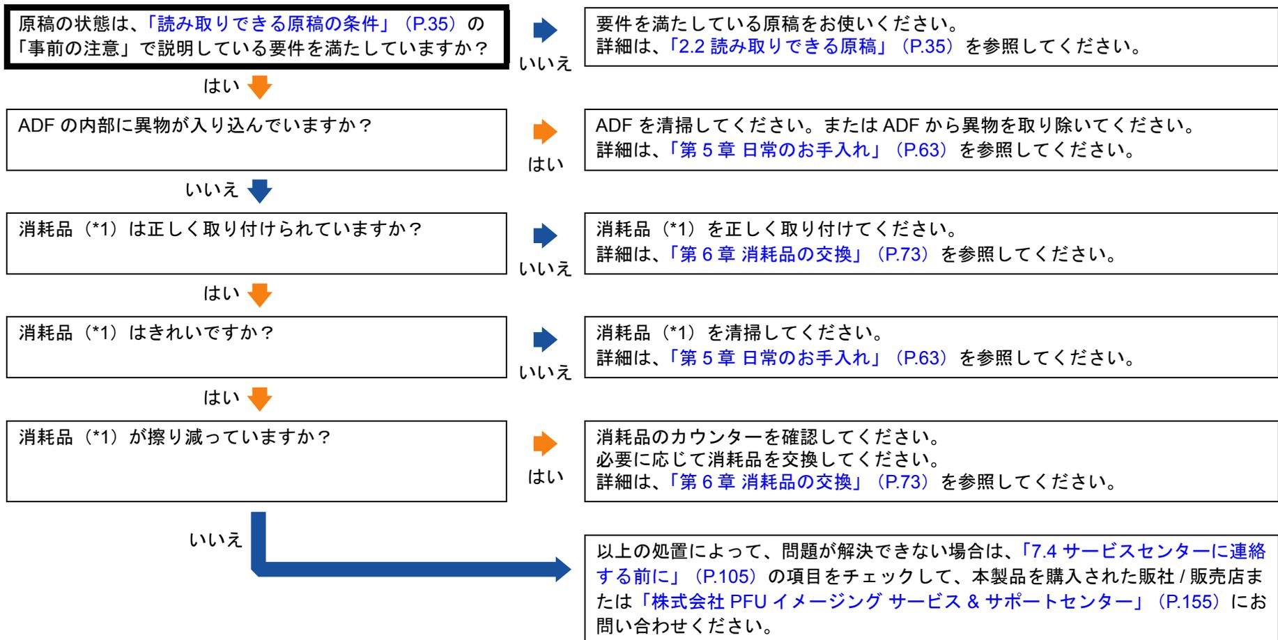
\*1: 消耗品とは、ローラーセット(ブレーキローラーおよびピックローラー)です。
