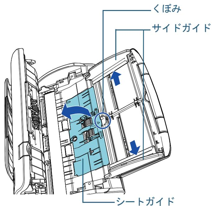
2 ピックローラーのレバーを、矢印の方向に回転させます。
