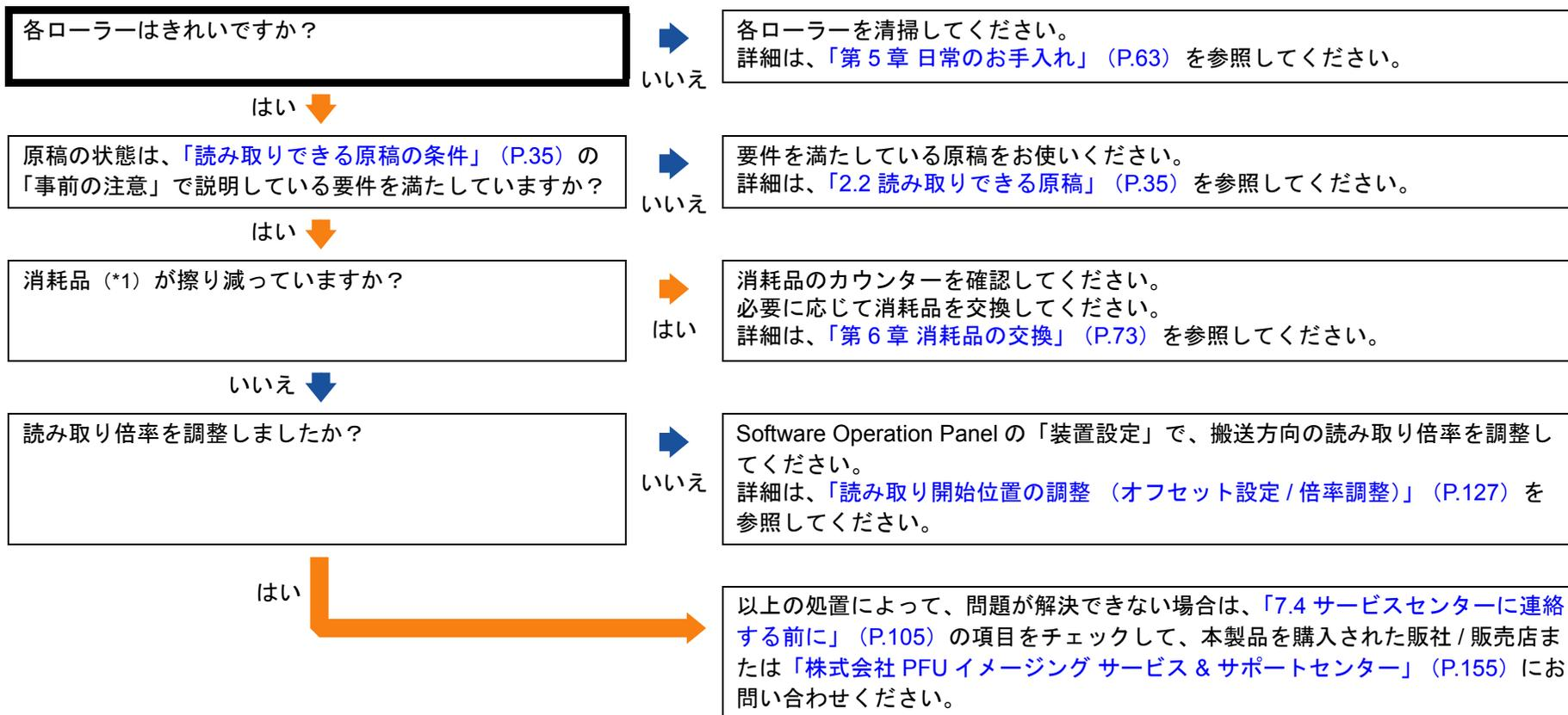
\*1：消耗品とは、ローラーセット（ブレーキローラーおよびピックローラー）です。
